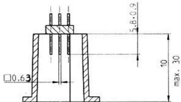
La siguiente ilustración muestra una clavija de acoplamiento típica de 6 patillas:
